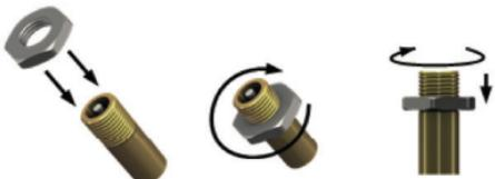
Vissez le capteur manuellement sur la valve et sécurisez le capteur avec l'écrou.
