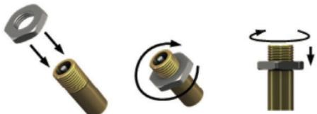
Schroef de sensor met de hand op het ventiel en borg de sensor met de borgmoer:
