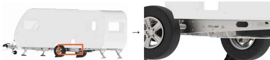
1. Aufnahme (Pos. 2) am vorgesehenen Lochbild des Längsträgers positionieren.
