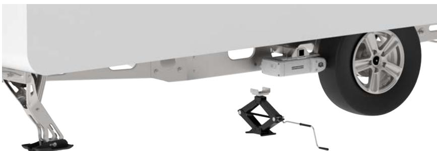
Durch die variable axiale Positionierung der Achsaufnahme ist ein sicheres und angepasstes Anheben des Anhängers an der Achse möglich.
