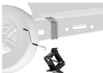
5. Der Wagenheber kann nun an beiden Längsträgern über die Aufnahme angesetzt und verwendet werden.
