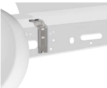
2. Zwei Sechskantschrauben mit jeweils einer Scheibe von der Vorderseite durch die Bohrungen einsetzen.
