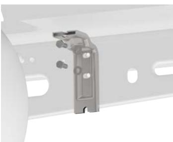
3. Je eine Scheibe und eine Sechskantmutter auf der Rückseite aufsetzen und die Aufnahme mit folgendem Anziehdrehmoment festziehen:
