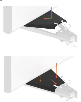
Valiéndose de los remaches, montar la cubierta de la lanza de tracción con la cubierta del dispositivo de inercia o bien a la escuadra de fijación.
