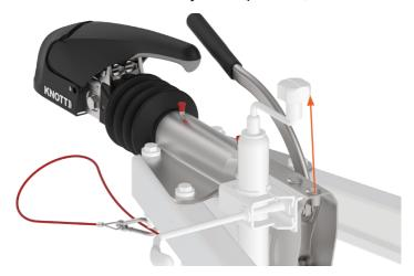
A continuación volver a apretar el tornillo con 75Nm.
