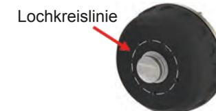
Kolbendurchmesser vom Radzylinder messen
