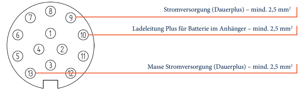
Belegung des 13-poligen Steckers gem. ISO11446:2004
